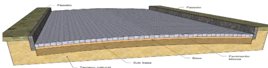
Figura 18 - Desenho esquemático do perfil transversal da pavimentação com blocos de concreto
